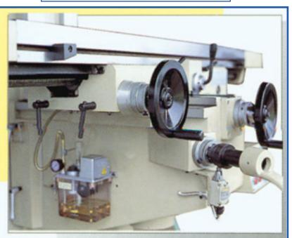
HEAVY-DUTY MEEHANITE CASTINGS \*AUTOMATIC CENTRAL LUBE \*POWERFEED TABLE \*HARDENED & GROUND BOX WAYS
